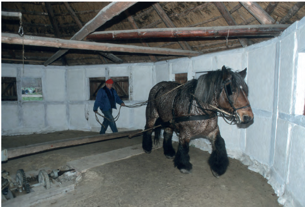
Med hestegangen blev hestekræfterne overført til tærskemaskiner eller andre maskiner, der befandt sig i laden (nr. 9).
